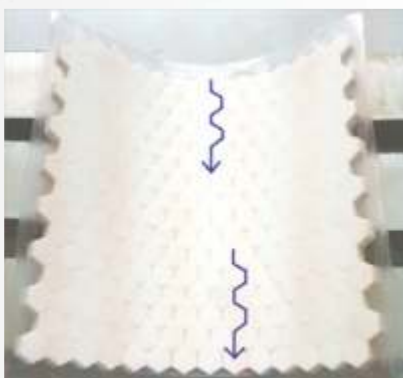
Траектория зигзагообразного стыка вдоль потока абразивных частиц
