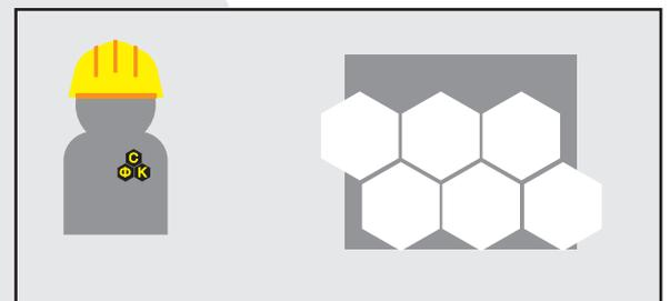
4.Нанесение керамического материала (клеевое, сварное, болтовое)
