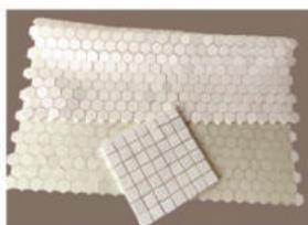
Монтажные маты (коврики) состоят из небольших мозаичных плит, наклеенных на ацетатный шелк или монтажную ПВХ пленку . Стандартные коврики: 500x500 мм. Стандартная толщина: 3-12мм. Коврики состоят из квадратной плитки 10x10 или 20x20 мм. или шестиугольной плитки SW20мм. Специальные размеры по запросу.
